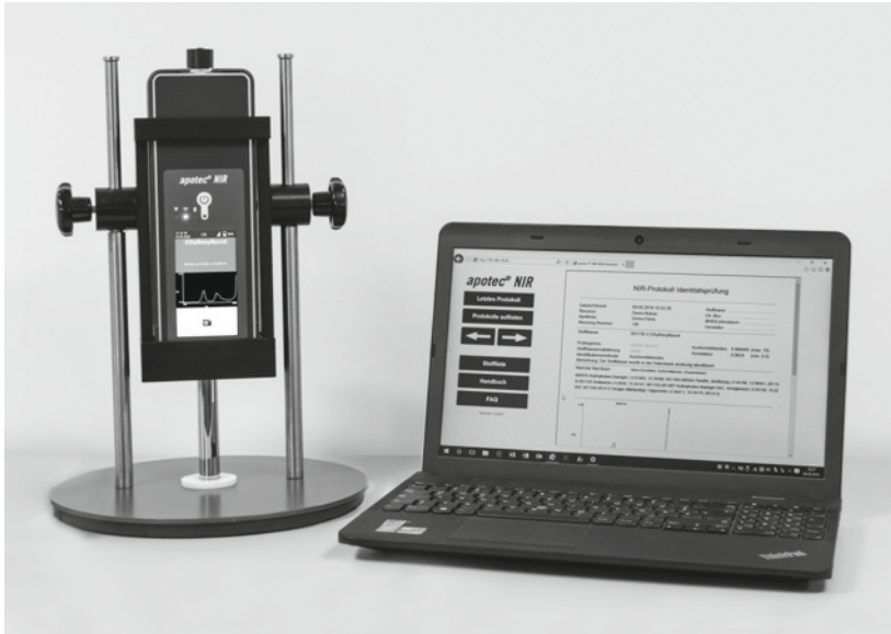
◉ Abb. 1.3 NIR-Spektroskop zur Prüfung von Ausgangsstoffen
