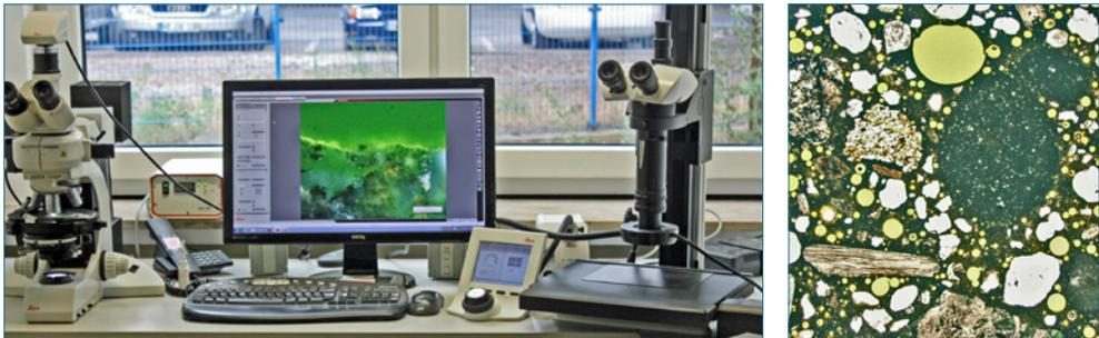
Bild 12: Bestimmung der Gehalte von Mikroluftporen an fließfähigen Betonen nach DIN EN 480-11
