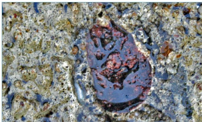
Bild 6: Zersetzliches Gesteinskorn im Zentrum einer Betonabwitterung
